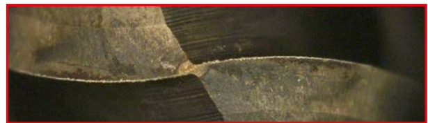
Estado del filo (desgaste de la cara de incidencia)
